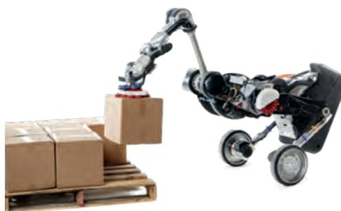
La préparation de colis peut également faire l'objet de cobotisation. Ainsi la société Boston-Robotics proposent un cobot « à deux jambes » capable de prélever des colis et de les déposer sur une palette.
