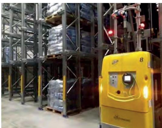
Source : Elettric80 (sur la photo un LGV pour Laser Guided Vehicle)
